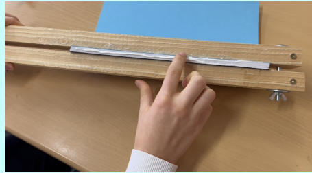
14. Holzleim mit einem Finger oder einem Pinsel sorgfältig verstreichen. Nach 10 min. zweite Leimschicht auftragen.
